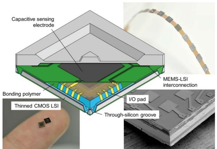
図2 ロボットのための集積化ネットワーク触覚センサ
