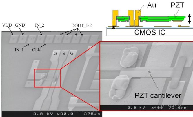
図1 LSI上に集積化したPZT MEMSスイッチ
