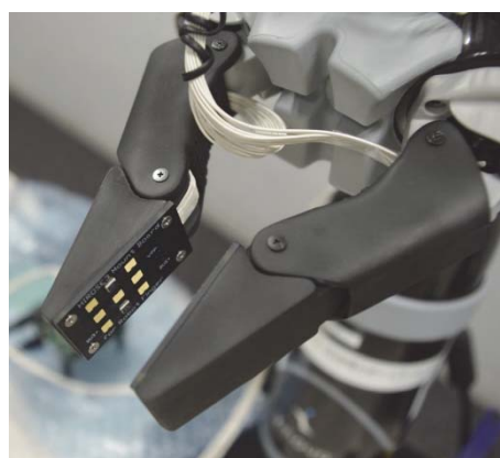
図1 ロボットアームに取り付けたバスネットワーク型集積化フィンガーセンサ
